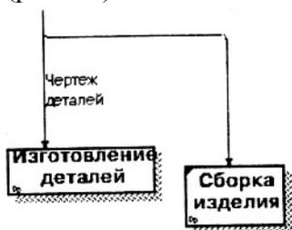
Рис. 14. Пример неверного именованной разветвляющейся стрелки
