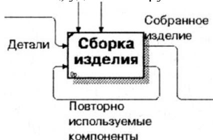
Рис. 26. Пример обратной циклической связи
